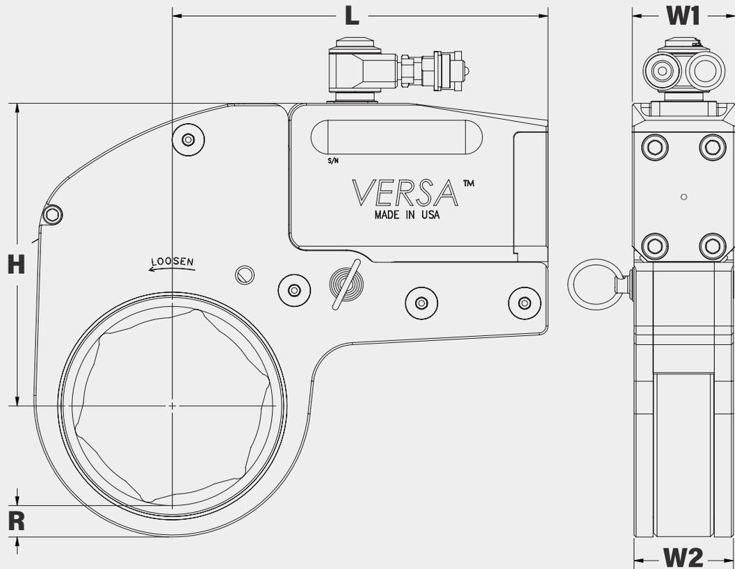
寸法 : H = 高さ W1 = パワーヘッドの横幅 W2 = リンクの横幅 R = 六角コーナーからの距離
