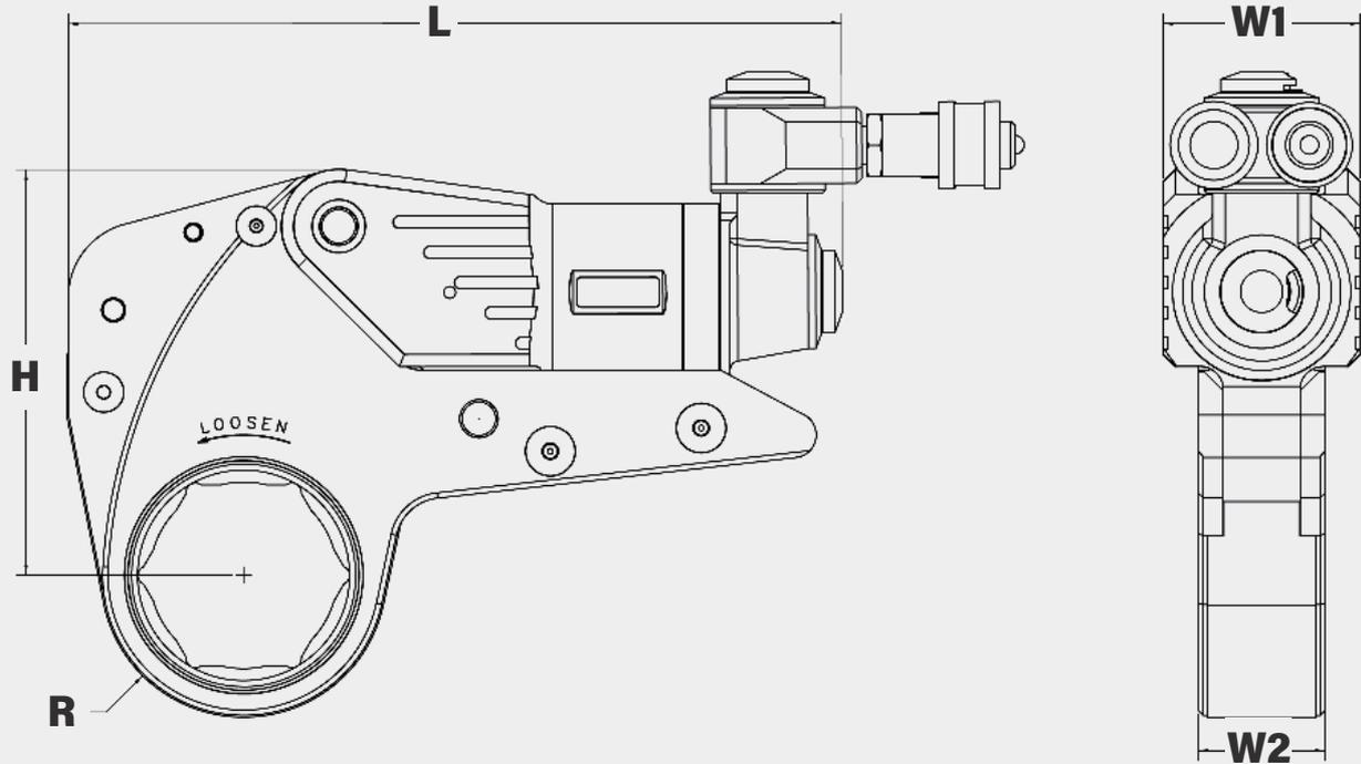
寸法: H = 高さ W1 = パワーヘッド横幅 W2 = リンク横幅 L = 長さ R = 半径
