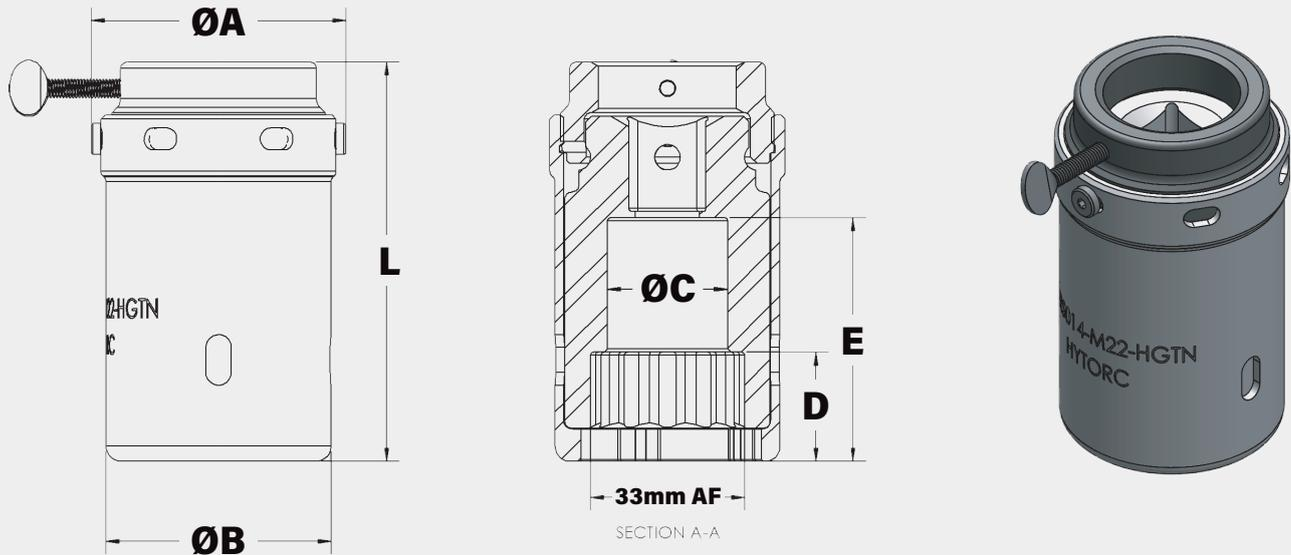
寸法: ØA = 外径 ØB = 内径 ØC = 直径 L = 長さ D = 六角ソケットの奥行 E = ボルトクリアランス深さ
