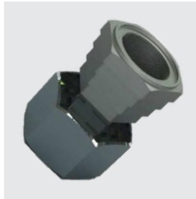
2つのパーツで構成されたデザインはインナースリーブとアウトースリーブを結合させ高い耐摩耗性を有したテーパードネジを採用しています。ハイトークガルフリーナットは標準的なボルトのねじ山と互換性があり、お客様が持つボルトの用途にあわせて様々なコーティングや素材で製作ができます。
