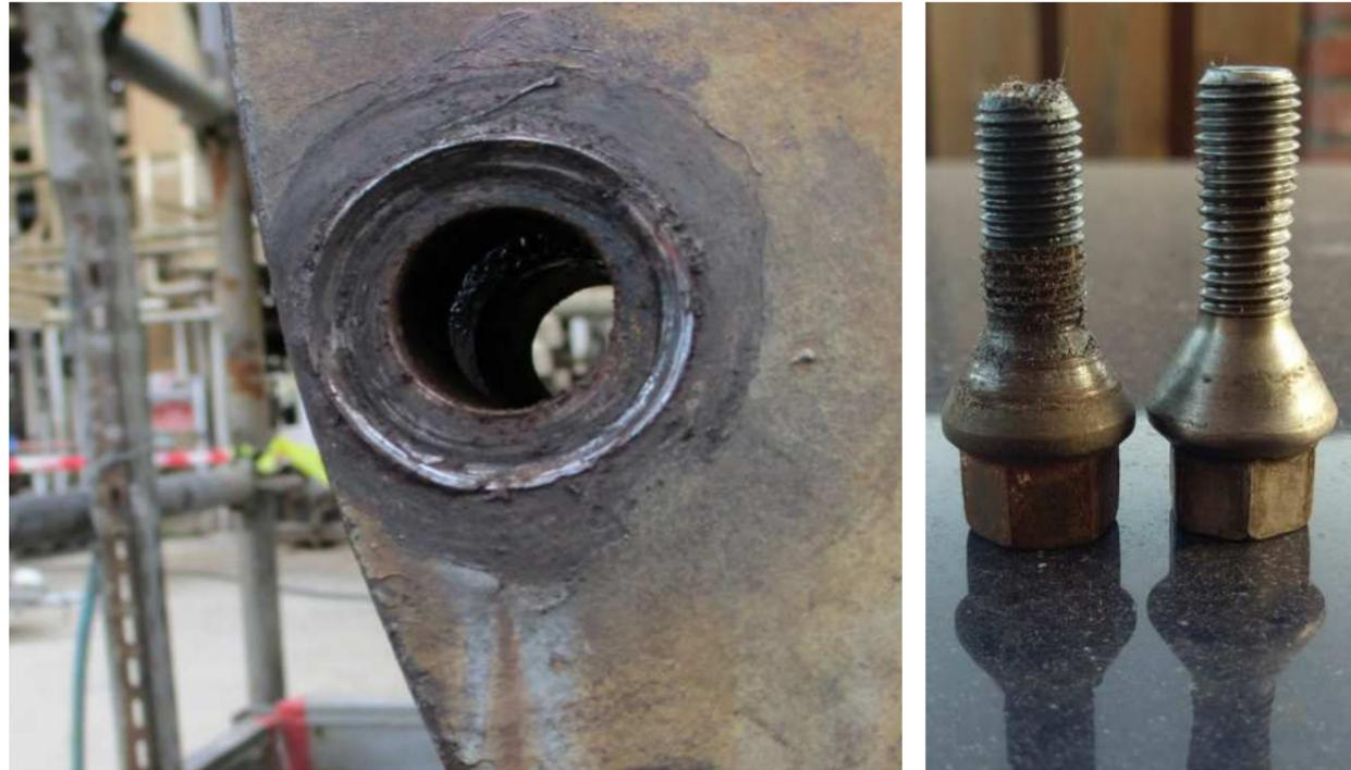
ハイトークガルフリーナットのコーティングされたねじ山の設計はボルトが熱や摩擦にさらされたときに発生する微小な金属の腐食を長期にわたって排除します。この技術は塑性変形によるかじりの影響やねじ部の金属結晶粒界の移動を抑制するものです。
